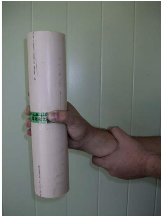
Figura 12b: Aplicação do cilindro de mensuração de pega
