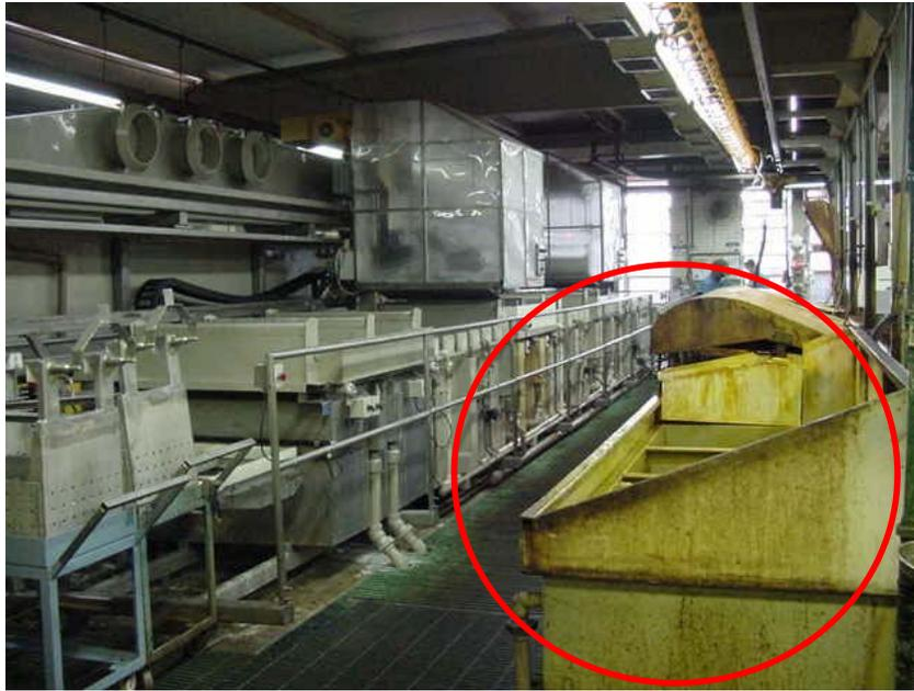
Figura 8: Célula de cromagem de cilindros, ilustrando a etapa 13 do fluxograma do processo de cromagem de cilindros. Destaque à direita, para os tanques de banho de cromo
