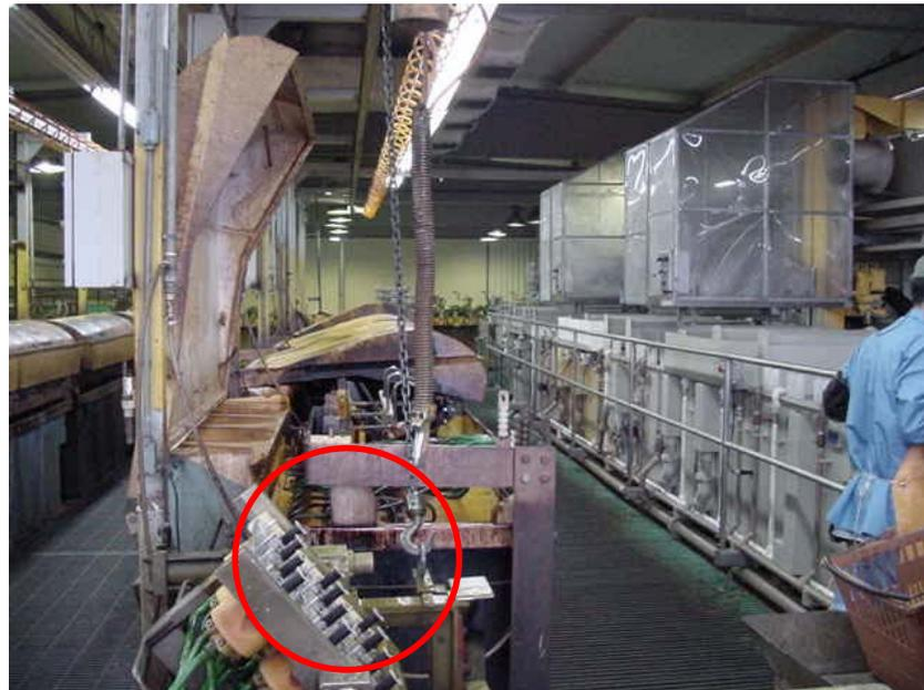
Figura 9: Célula de cromagem de cilindros, que ilustra a finalização da etapa 13 do fluxograma do processo de cromagem de cilindros. Destaque, para o dispositivo de cromagem
