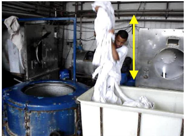
Figura 4 – Carregamento da centrífuga
