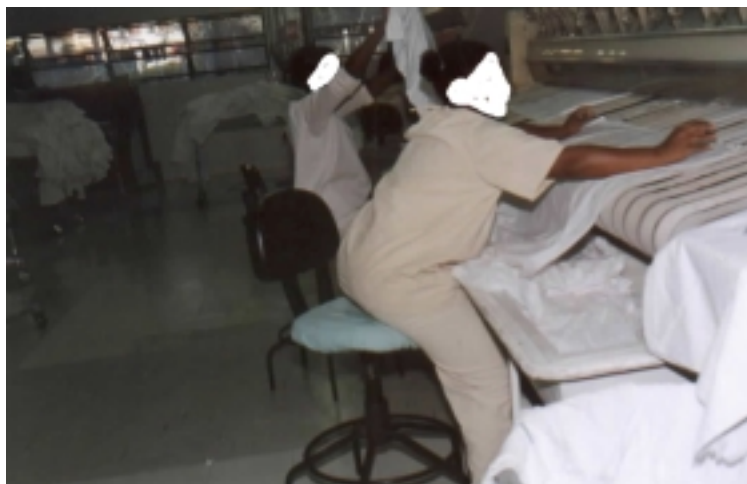
Figura 11 – Funcionária realizando atividade no posto da Calandra – colocação das peças de roupa na calandra
